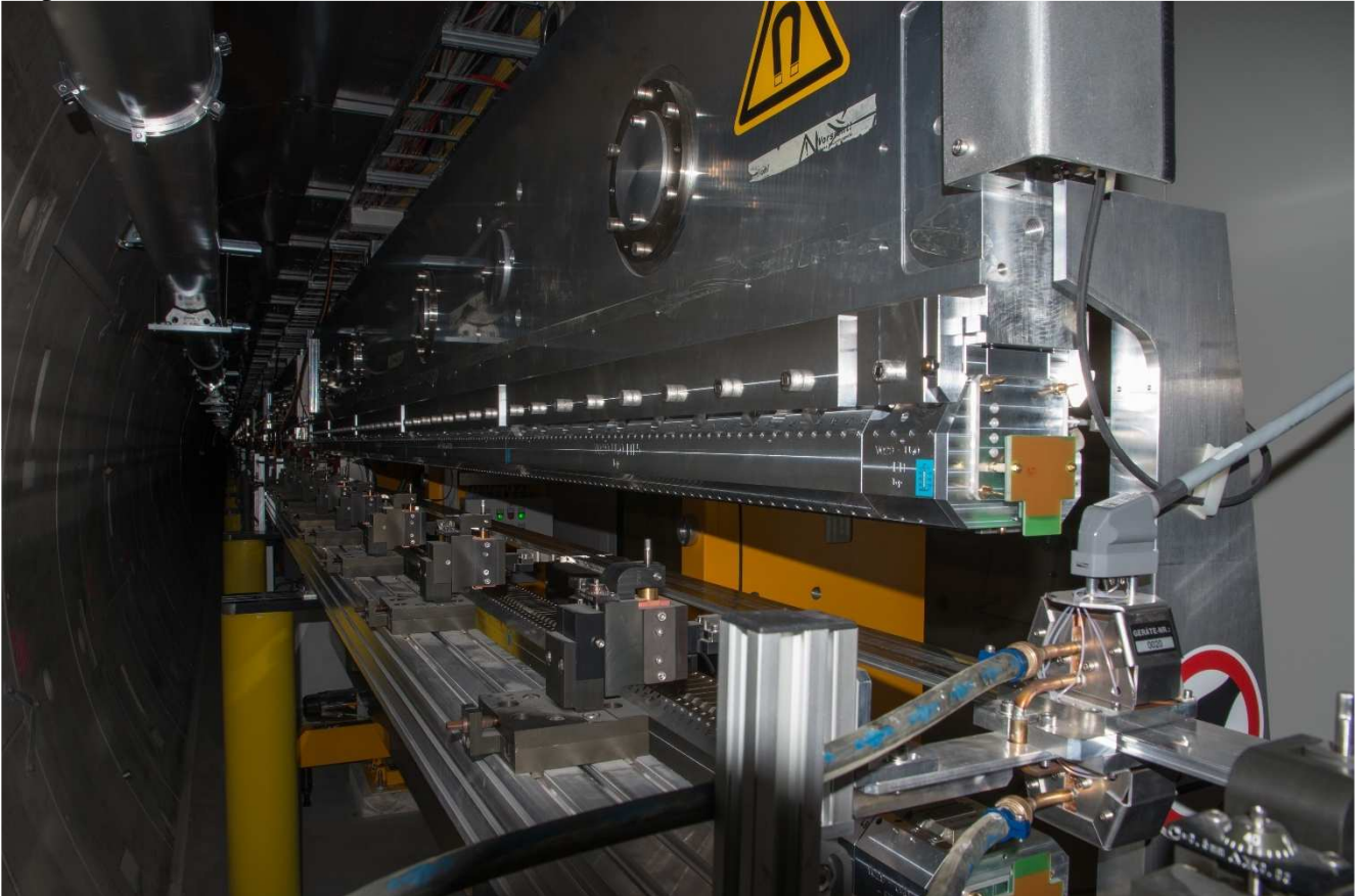
Undulator mit geöffnetem Gap. Blick in Strahlrichtung, links ist die Tunnelwand. Im Vordergrund, rechts die beiden Radfetplatinen(Grün und braun).
